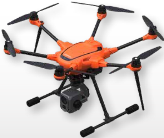
YUNEEC „TYPHOON H520E“ mit „ETX“-Wärmebild- und Restlichtkamera
